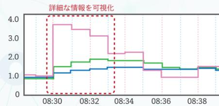
情報の収集間隔によって、性能状況の見え方は大きく異なります。高精度かつ詳細な性能分析をおこなうには、1分間隔での性能情報が必要であると考えます。
