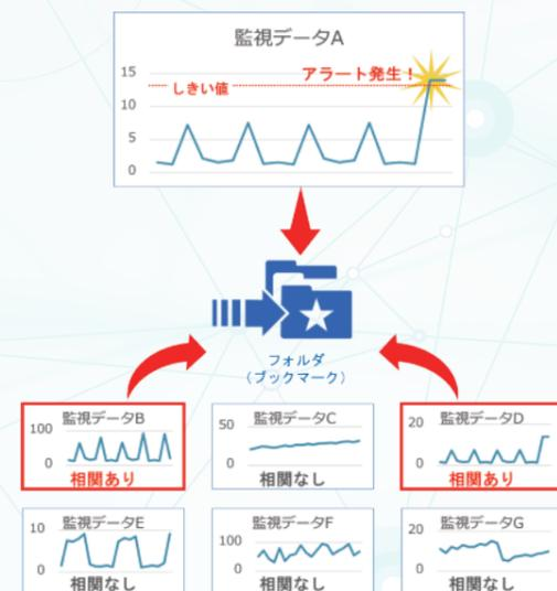
アラートが発生した場合、一般的にはアラートが挙がった機器やその機器が設置してある拠点のネットワークの問題かどうかを最初に確認しますが、根本的な原因は別の場所にあるケースもあります。
