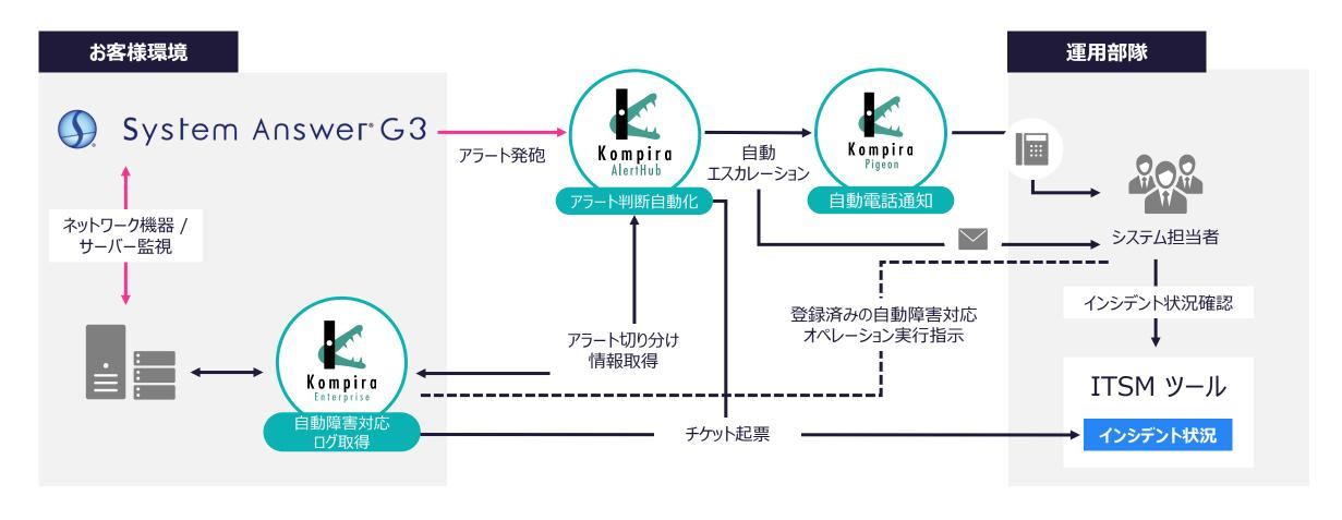
System Answer G3 で検知したアラートを AlertHub で切り分け、緊急アラートは Pigeon で電話通知。 システム担当者は障害状況を ITSM ツールで確認し、Kompira Enterprise へ自動障害対応指示。
